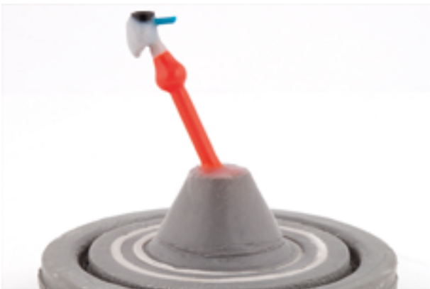
Figura 4 y 5. Encerado listo para ser colado.
